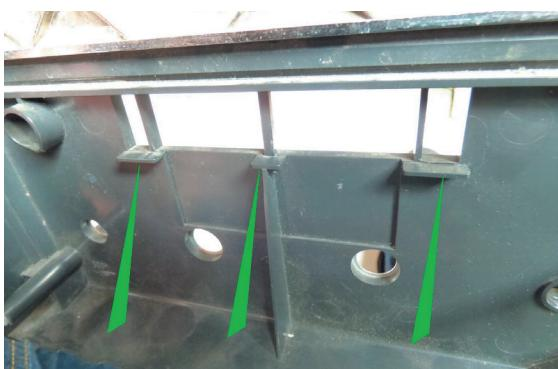
12 - Sur les Mk1 et Mk2, l'intérieur de la façade inférieure présente des logements qui rendent la chose plus difficile. Il vous est éventuellement possible de décoller les «blocs-carreaux» supérieurs des vu-mètres avec un cutter très fin pour les fixer à l'intérieur de la façade avec du ruban adhésif. Dans ce cas, il vous faudra être prudent lors de la remise en place de la façade pour ne pas endommager l'aiguille des vu-mètres.
