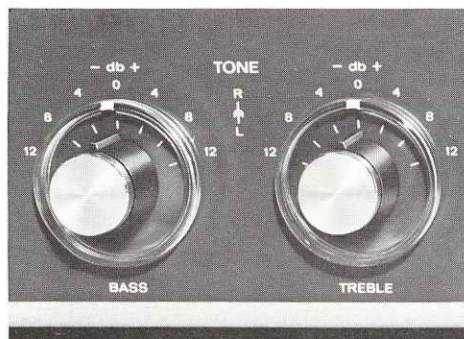
① Stufenklangregler ermöglichen eine exakte Stellung (Linear) und eine jederzeitige Reproduzierbarkeit des Klangbildes.
