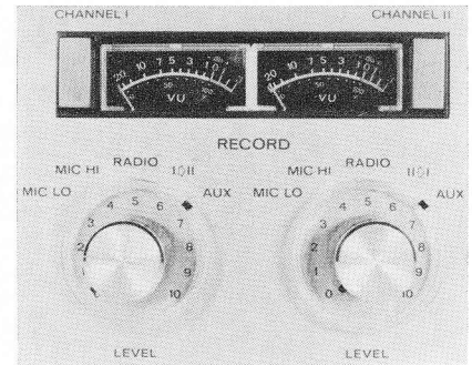
2 Bedienungs- und Kontrollelemente für den Aufnahmeteil der REVOX A 77. (Neben den beiden Aussteuerungsinstrumenten befinden sich die Kanal-Wahltasten, darunter die Eingangswahlschalter und die Aufsprechepegelregler für die Aufnahmeverstärker.)
