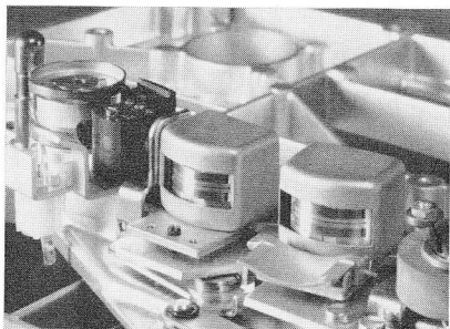
7 Druckguß-Kopfträger der REVOX A 77 mit Löschkopf, abgeschirmtem Aufsprech- und Wiedergabekopf. (Links neben dem Löschkopf befindet sich der Fotowiderstand, davor die Lampe zur Auflösung der automatischen Bandabschaltung.)
