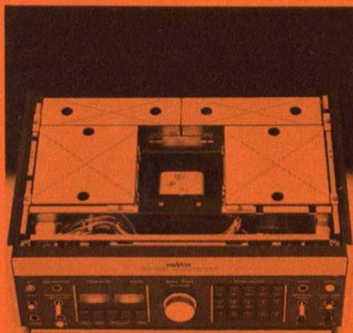
△ L'électronique HF, FI, MPX et BF est équipée d'un blindage intégral.
